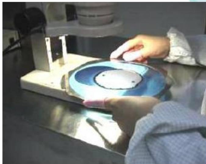
主要是针对**Wafer Saw**之后在显微镜下进行**Wafer**的外观检查，是否有出现废品。
