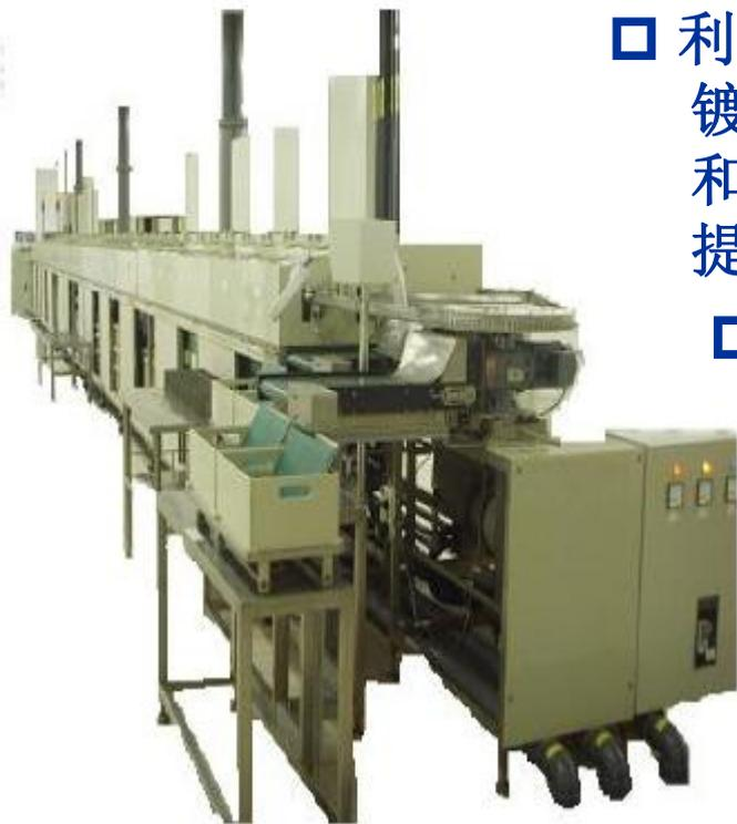
□ 利用金属和化学的方法，在**Leadframe**的表面镀上一层镀层，以防止外界环境的影响（潮湿和热）。并且使元器件在**PCB**板上容易焊接及提高导电性。
