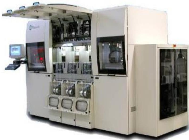
※为了防止外部环境的冲击，利用**EMC**把**Wire Bonding**完成后的产品封装起来的过程，并需要加热硬化。
